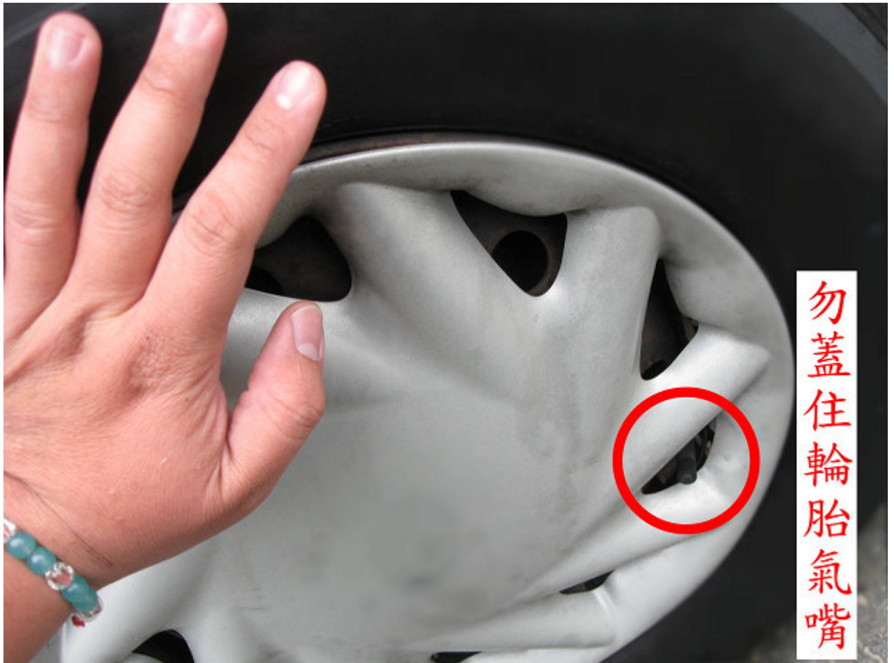
圖 19 對準後，以手拍擊裝回輪圈蓋
