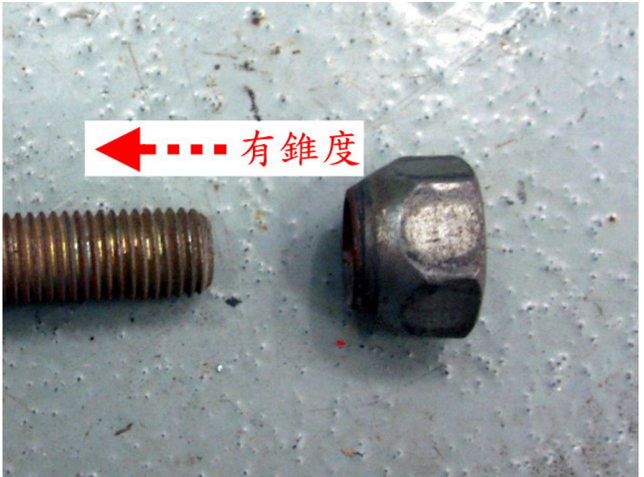
圖 17 螺帽有錐度側需朝內側安裝
